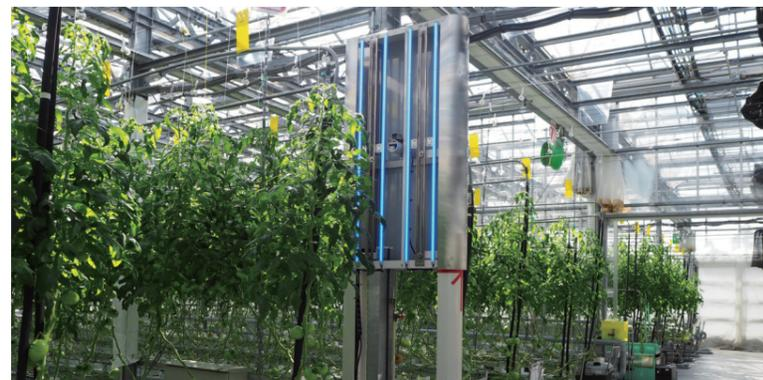
愛媛大学のトマト栽培に使われている、植物の生体情報を計測するロボット。
