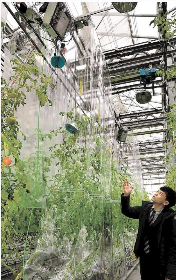
植物の光合成と蒸散を計測しリアルタイムに数値化する装置 || 松山市樽味3丁目の愛媛大植物工場
